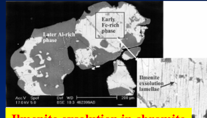
Ilmenite exsolution in chromite
